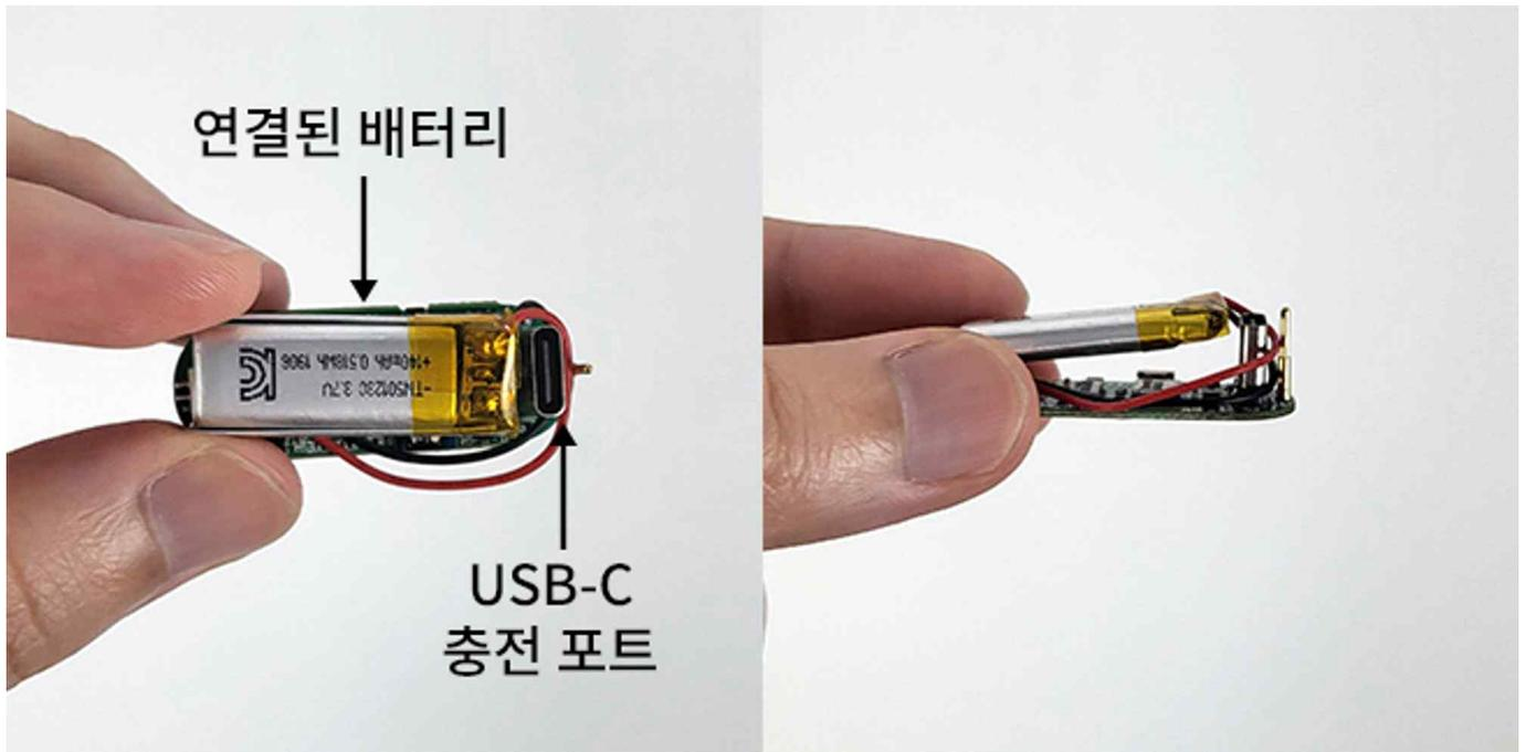
[ 사진2. 배터리 및 충전 포트 이미지 ]
