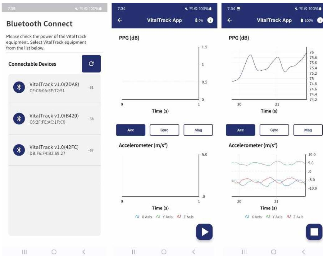
[ 사진4. 좌측부터 VitalTrack - PPG&Motion App 연결화면, 메인화면(측정 시작 전), 메인화면(측정 시작 후) ]
